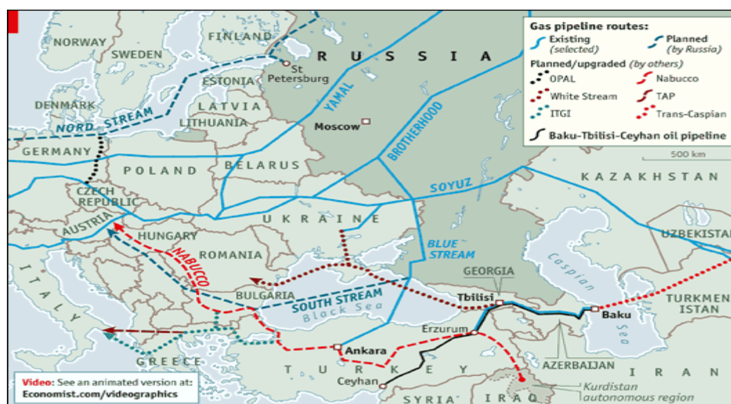
Σχήμα 3.16 : Υφιστάμενοι και οι σχεδιαζόμενοι αγωγοί φυσικού αερίου
