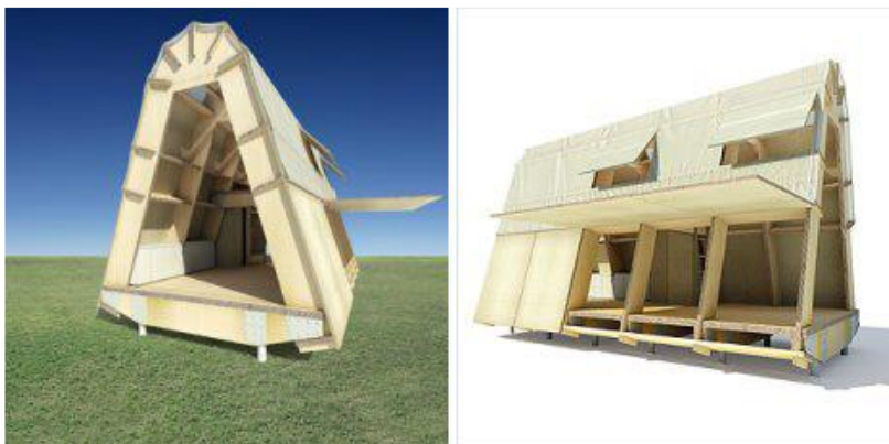
Σχήμα 54 - Προκατασκευασμένο κτίριο από φύλλα χαρτονιού
