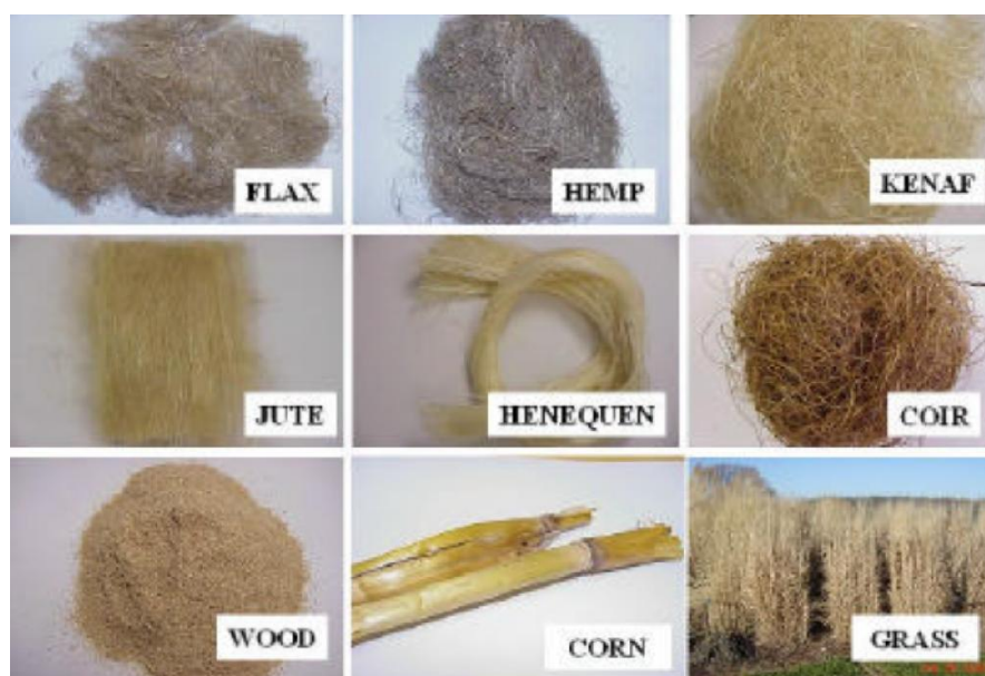
Σχήμα 3.2: Διάφορα είδη και πηγές βιο-ινών (Drzal et al 2004.)
