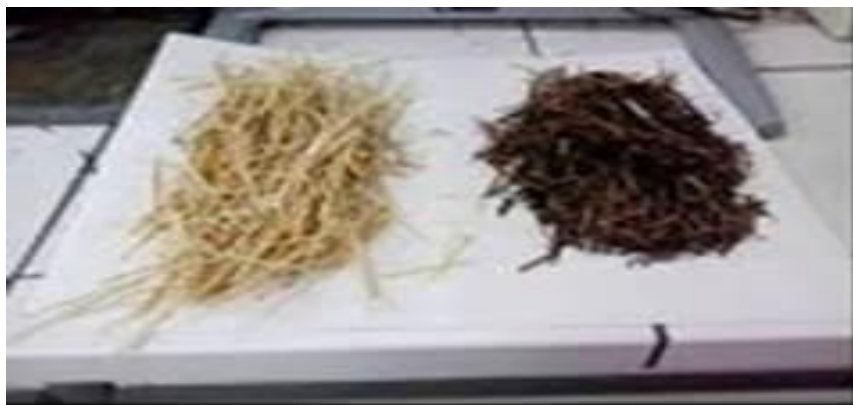
Σχήμα 5.3 : Απροκατέργαστο (αριστερά) και Προκατεργασμένο (δεξιά) Άχυρο Σιταριού (0,45M θειικό οξύ στους 100°C για 4h)
