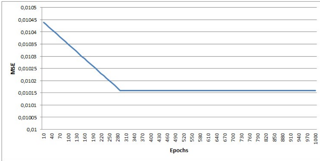
Εικόνα 41: πειραματικά αποτελέσματα του αλγορίθμου Οπισθοδιάδοσης του Λάθους ( BP ) για το σύνολο δεδομένων Cloud . Παρατηρούμε ότι ο αλγόριθμος BP αρχίζει να συγκλίνει προς την χαμηλότερη τιμή του MSE μετά από περίπου 300 εποχές . Η μικρότερη τιμή του MSE είναι περίπου ίση με 0.01015 .
