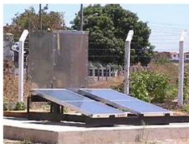
Εικόνα 2.2.6: Σύστημα αφαλάτωσης με ηλιακή απόσταξη
