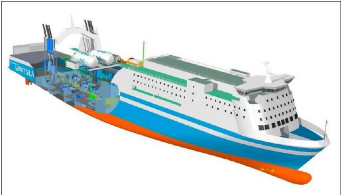
Σχήμα 9. Οχηματαγωγό πλοίο που τροφοδοτείται με LNG σε λειτουργία (AEA 2008)
