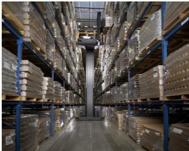
Εικόνα 9.6.1-1: Σύστημα αποθήκευσης πολύ στενών διαδρόμων. Πηγή Crown Corporation
