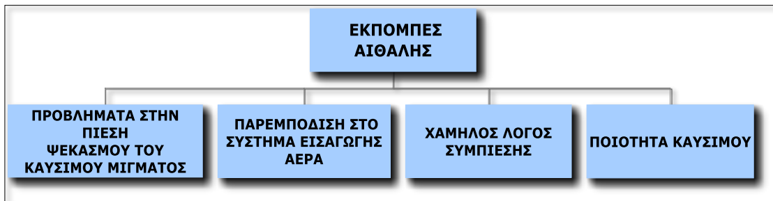
Εικόνα 3.3 Κυριότερες αιτίες εκπομπών αιθάλης από Μ.Ε.Κ.
