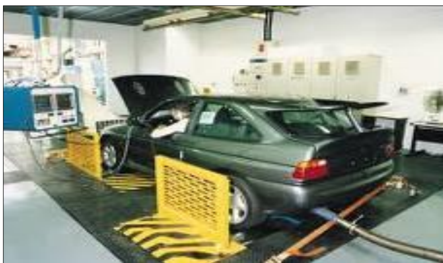
Εικόνα 4.2 Δυναμόμετρο τύπου chassis πραγματοποιεί μέτρηση
