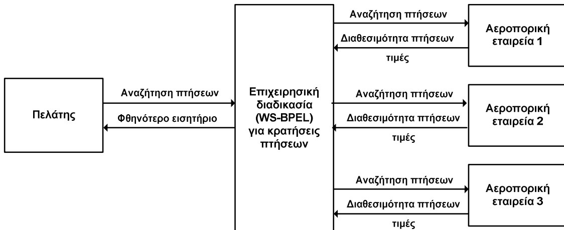
Εικόνα 7 Παράδειγμα επιχειρησιακής διαδικασίας κράτησης πτήσεων υλοποιημένης σε WS-BPEL
