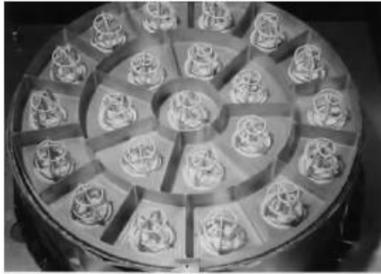
Σχήμα 64 : Στοιχειοκεραία του δορυφόρου Inmarsat 3[7]
