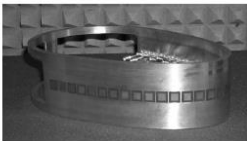
Σχήμα 50 : Μη επίπεδη Στοιχειοκεραία σε Σχήμα Έλλειψης [5]
