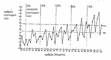
Σχήμα 3. 13 επίδραση της αύξησης του ποσοστού ελαττωματικών
