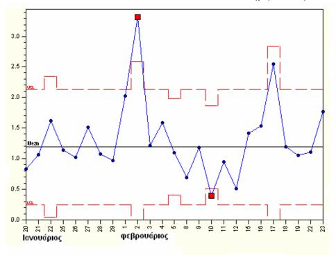
Σχήμα 3. 14 παράδειγμα διαγράμματος np
