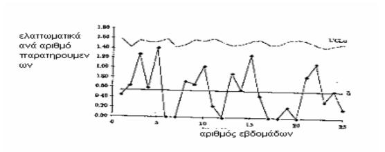
Σχήμα 3. 17 παράδειγμα διαγράμματος υ με μεταβλητά όρια
