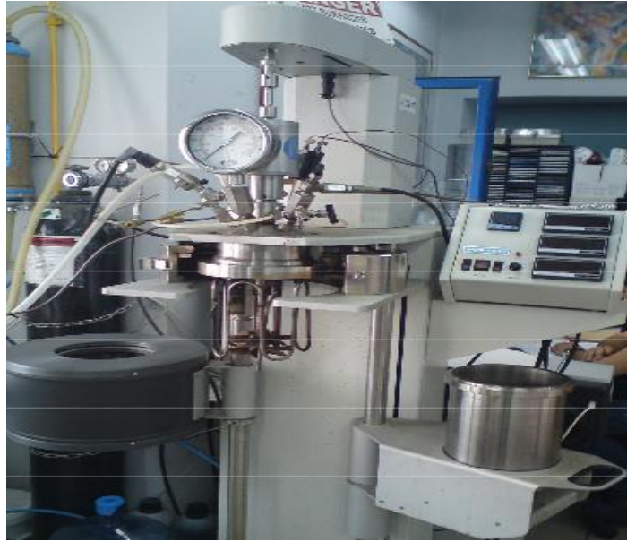
Εικόνα 4.5: Το αυτόκλειστο όπου διακρίνονται το δοχείο, η βάση του δοχείου και ο θερμαντικός μανδύας που περιβάλλει το δοχείο
