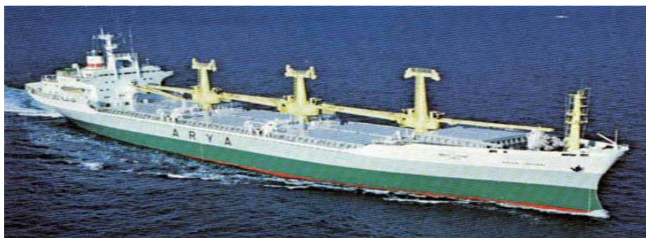
Εικόνα 5 : Πλοίο Ore/Bulk/Oil μεταφοράς σιδηρομεταλλεύματος/ξηρου φορτίου/πετρελαίου ταυτόχρονα 24
