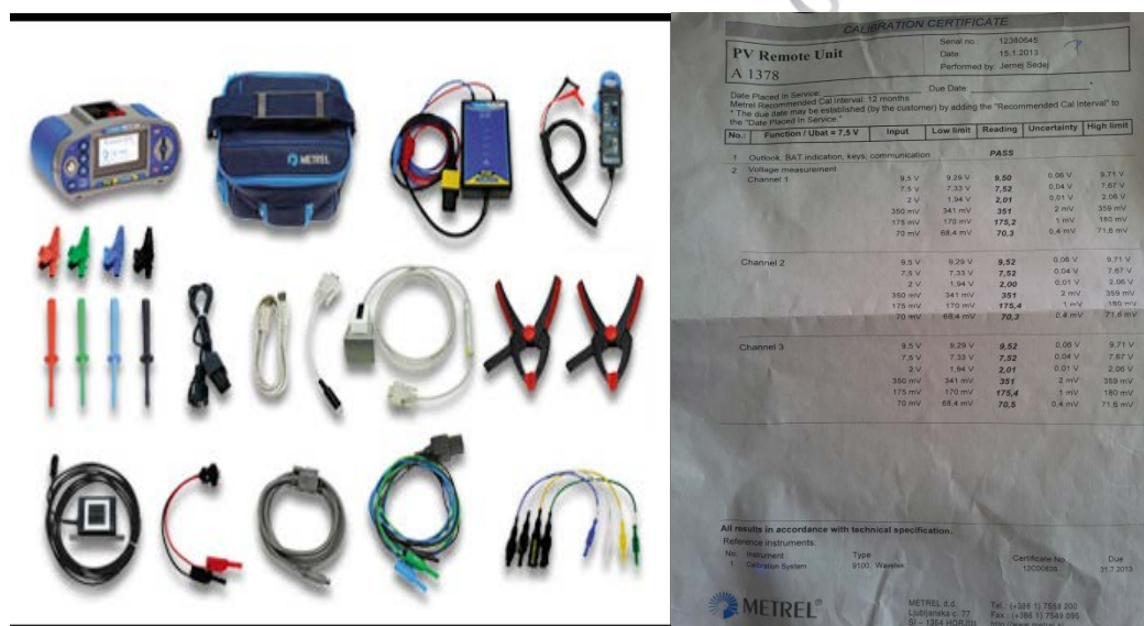
ΕΙΚΟΝΑ 4.29. Διάταξη οργάνου METREL (MI 3108 EUROTEST PV) με τα παρελκόμενα του και το πιστοποιητικό διακρίβωσης (ημερ.λήξης 31.07.2013) που χρησιμοποιήθηκε στις μετρήσεις που περιέχονται στην εργασία.
