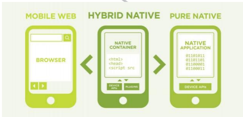
Σχήμα 18: Αποτύπωση του τρόπου λειτουργίας των διαφορετικών προσεγγίσεων σε εφαρμογές για έξυπνες συσκευές (brightIDEAS, 2012)
