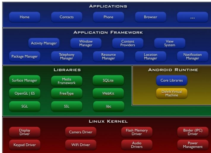
Σχήμα 19: Αρχιτεκτονική του Android (Embedded Linux Wiki, 2011)
