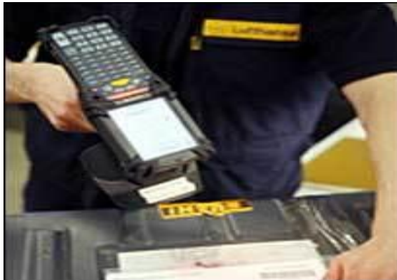
Εικόνα 4.1: Τεχνικός της Lufthansa χρησιμοποιεί φορητό ανακριτή, για την ανάγνωση των εντύπων συντήρησης που φέρουν ετικέτα και που συνοδεύουν παρελκόμενα των Α/Φ, (πηγή [32]: http://www.rfidjournal.com/aerospace/news/9 )
