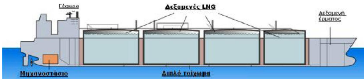
Εικόνα 1: Τομή Πλοίου LNG τύπου μεμβράνης (Μκ. III)
