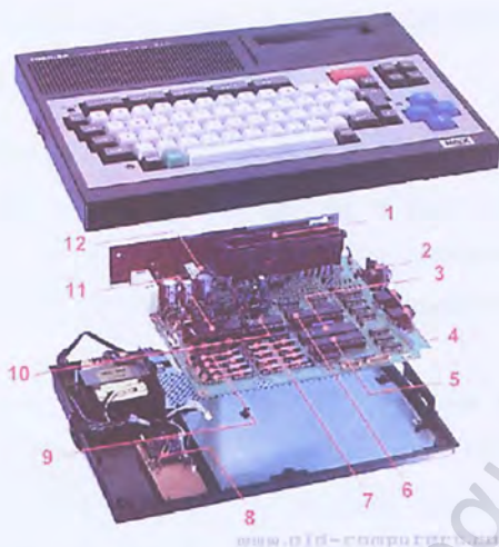
Ένας τυπικός home computer (Toshiba HX-10 MSX), και τα τμήματά του. Διακρίνεται η κεντρική πλακέτα, αριστερά το τροφοδοτικό με το μετασχηματιστή του, καθώς και το πληκτρολόγιο και το κουτί του (σασί)
