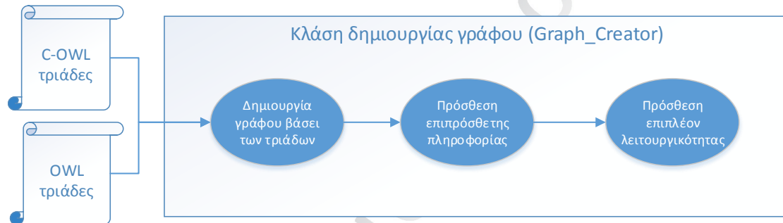
Εικόνα 10: Λειτουργία κλάσης δημιουργίας γράφου (graph_creator).
