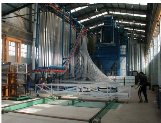
Εικόνα 7: Εικόνα από σύγχρονο καθετοποιημένο βαφείο ηλεκτροστατικής βαφής
