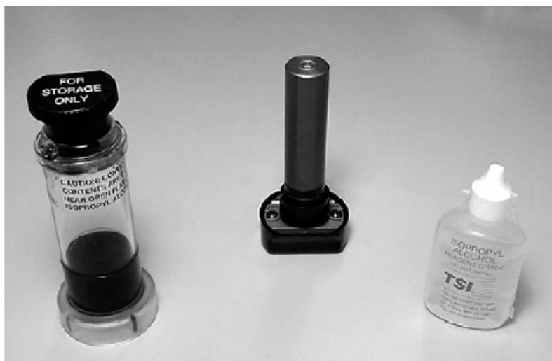
Εικόνα 10.7: Η κάμουλα αλκοόλης, η κεφαλή και το φιαλίδιο πλήρωσης (κατά σειρά).
