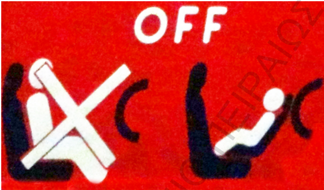
Σχήμα 6.1.1.11: Απαγορεύεται η τοποθέτηση του παιδικού καθίσματος στη θέση συνοδηγού, αν ΔΕΝ ΑΠΕΝΕΡΓΟΠΟΙΗΘΕΙ ο αερόσακος του συνοδηγού.
