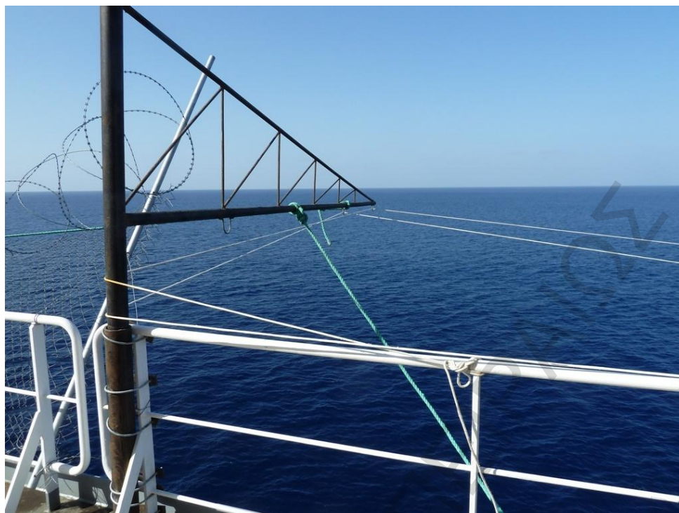
Εικόνα 15: Στηρίγματα και προέκταση για τις παγίδες προπέλας
