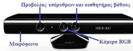
Εικόνα 2: Τα μέρη που αποτελείται η κάμερα Kinect
