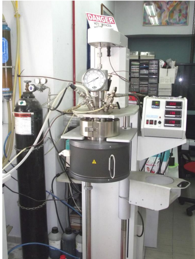
Εικόνα 5.1. Αυτόκλειστο όπου διακρίνονται το δοχείο, η βάση του δοχείου και ο θερμαντικός μανδύας που περιβάλλει το δοχείο.
