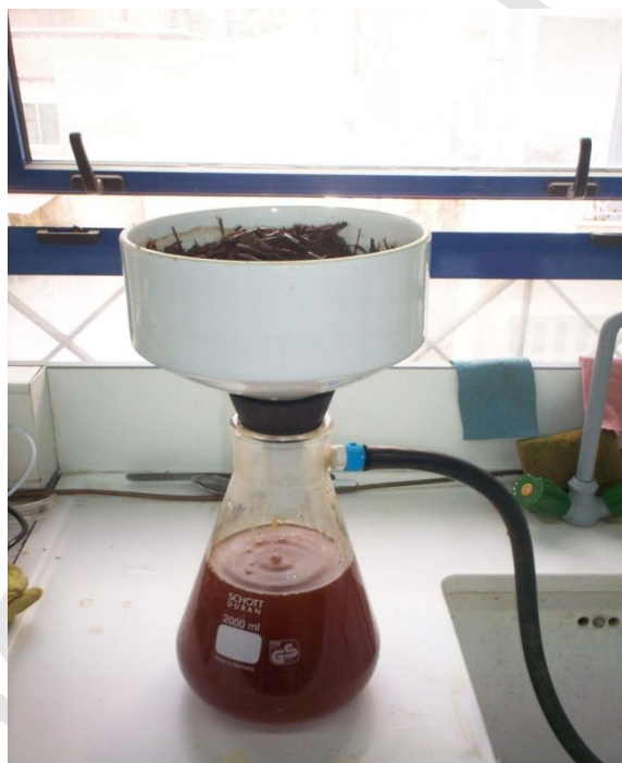
Εικόνα 5.3. Ηθμός Buchner όπου γίνεται η διήθηση του υλικού υπό κενό.
