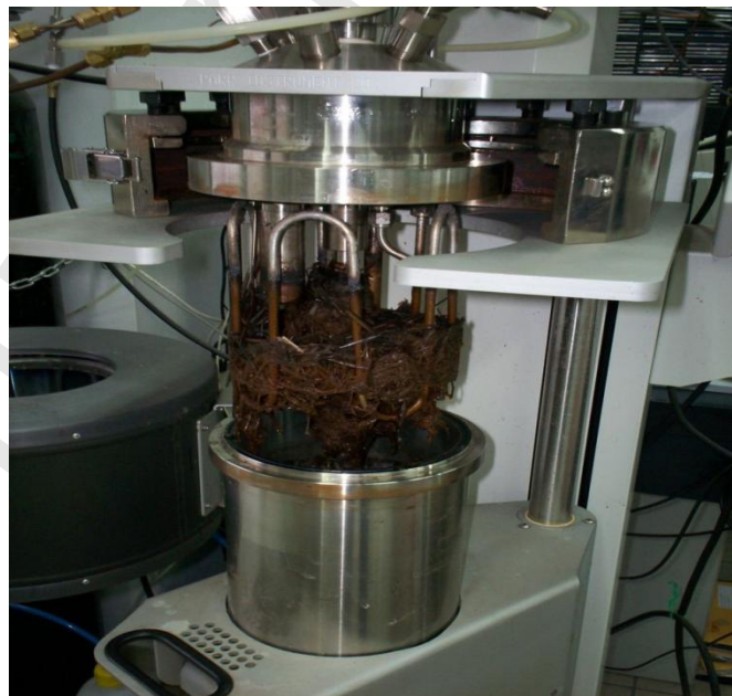
Εικόνας 5.2. Αυτόκλειστου αμέσως μετά το τέλος της αντίδρασης όπου διακρίνεται το δείγμα άχυρου που έχει υδρολυθεί.
