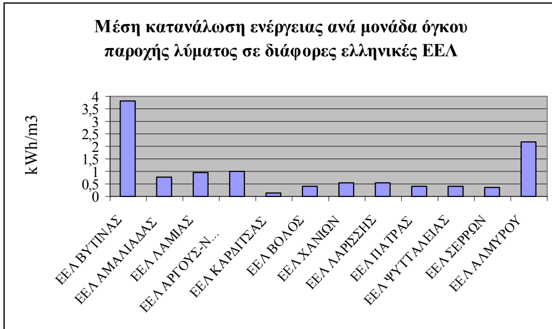
Διάγραμμα 5.5: Γραφική απεικόνιση της κατανάλωσης ενέργειας ανά κυβικό μέτρο παροχής προς επεξεργασία λύματος στην ΕΕΛ Βυτίνας και σε 11 άλλες ΕΕΛ στην Ελλάδα.
