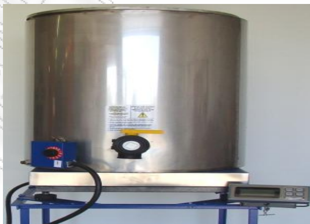
Εικόνα 5.3 Δεξαμενή Λιωσίματος Λαδιού
