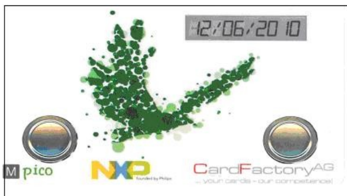
Εικόνα 18: RFID ετικέτα με τεχνολογία οθόνης και κουμπιά
