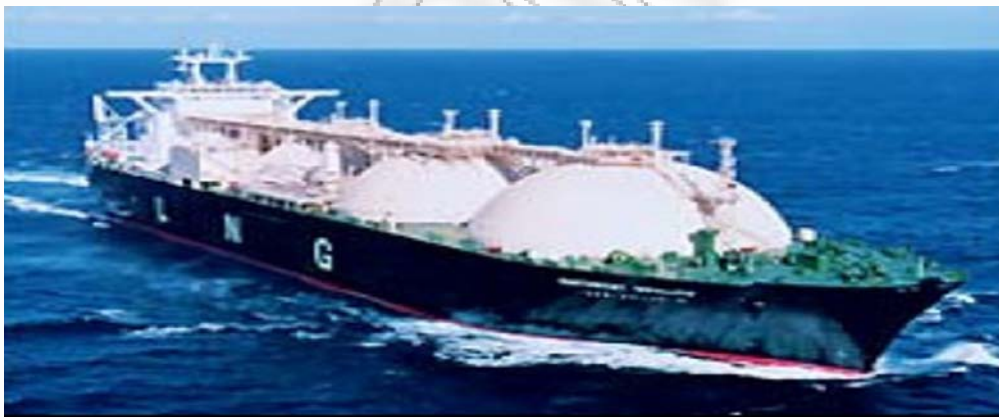
Εικόνα 1.1: LNG Carrier –(Σφαιρικού Moss Σχεδιασμός) (Πηγή:The international group of lng importers, 2009)
