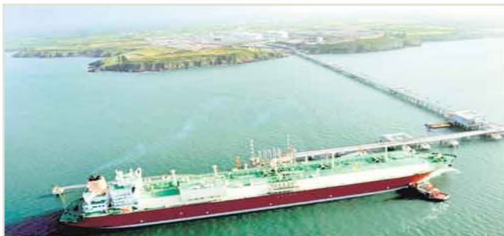
Εικόνα 1.2 : Δεξαμενόπλοιο ΥΦΑ τύπου Q-MAX σχεδιασμού μεμβράνης με χωρητικότητα 266.000 m 3 (Πηγή :The international group of lng importers, 2009)
