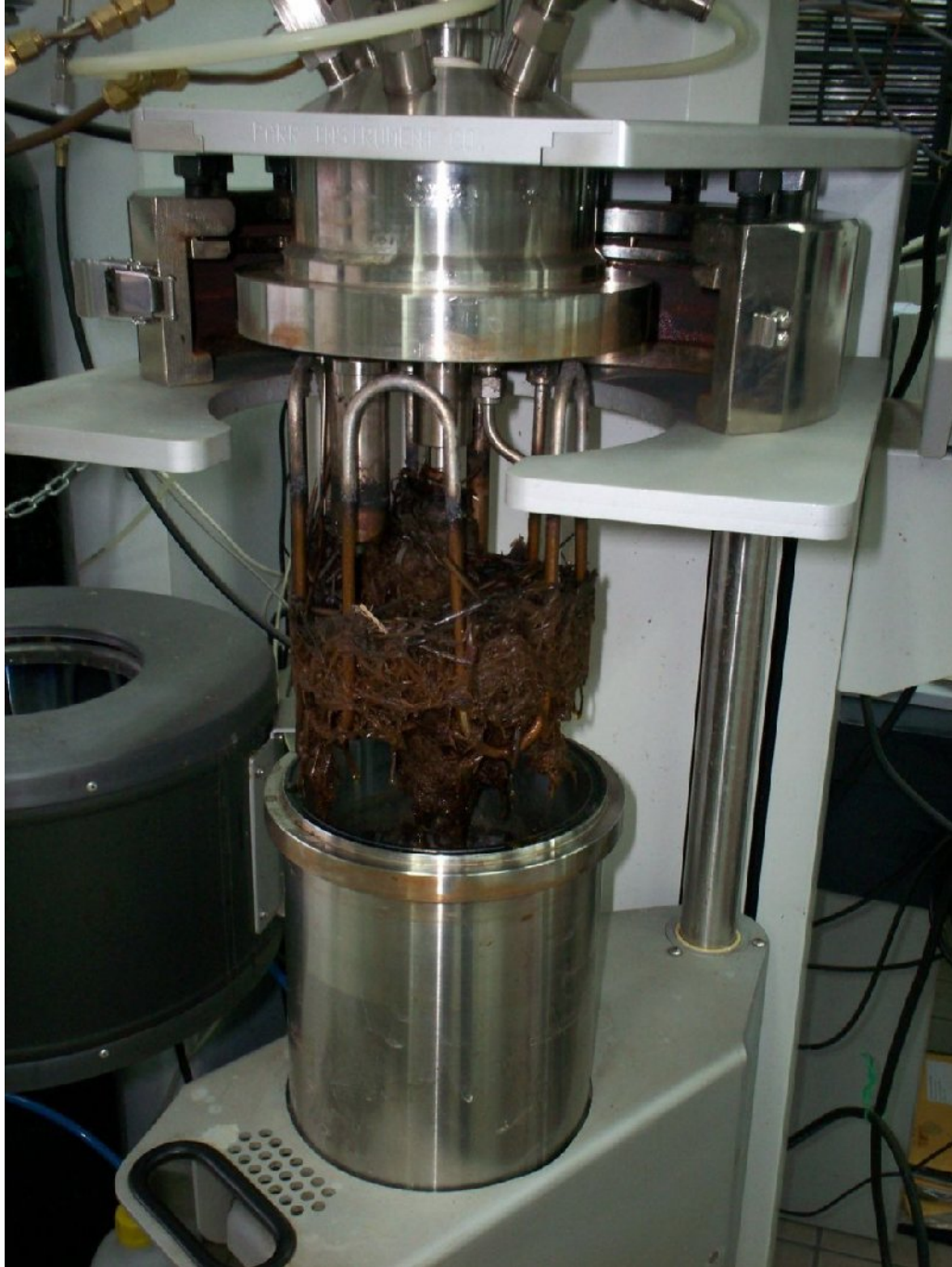
Εικόνα 4.3: Εικόνα του αυτόκλειστου αμέσως μετά το τέλος της αντίδρασης. Διακρίνεται το ανοιχτό δοχείο εντός της βάσης του και το δείγμα άχρρου που έχει υποστεί αντίδραση.
