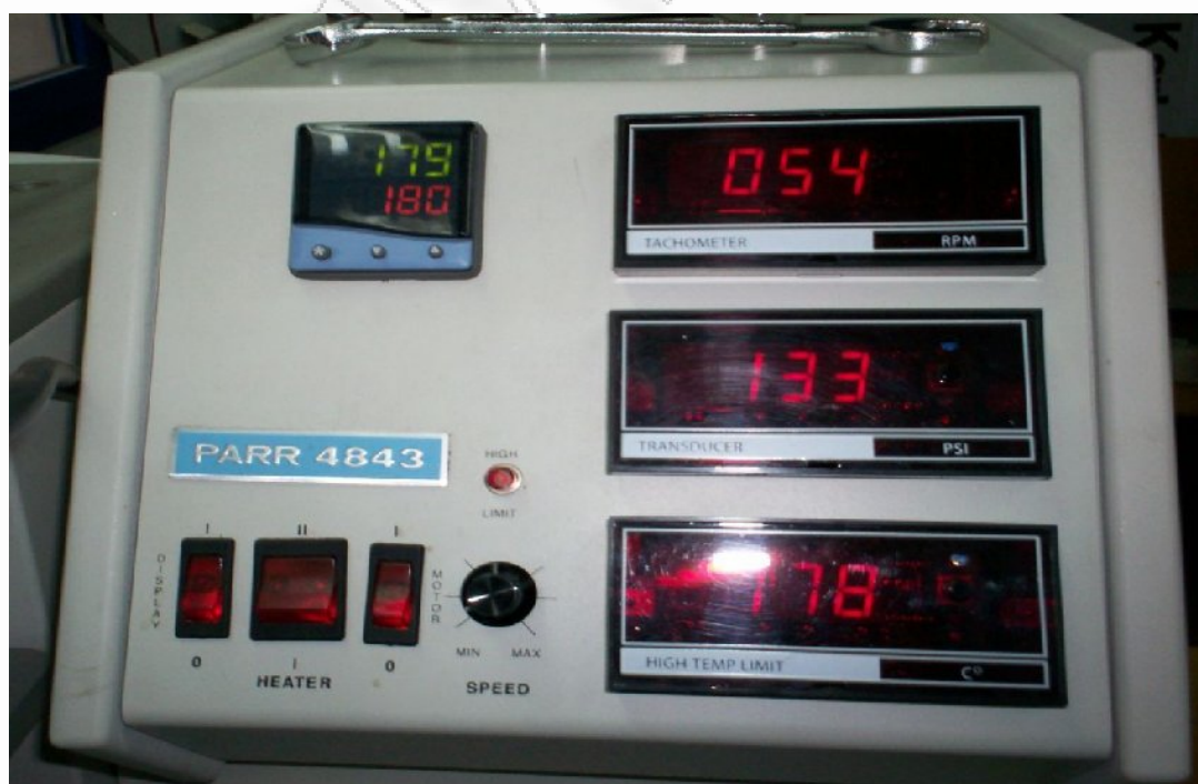
Εικόνα 4.1: Οθόνη ελέγχου CONTROLLER PARR 4843
