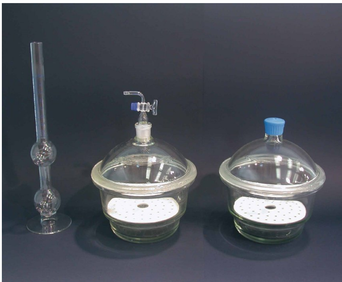
Εικόνα 1.13 : Ξηραντήρια όπου τοποθετούνται οι κάψες και τα υλικά που συμμετέχουν στο στάδιο της ξήρανσης
