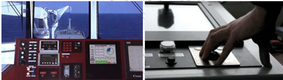
Εικόνα 3.7: Συστήματα ελέγχου του «χαρταετού» στη γέφυρα του πλοίου
