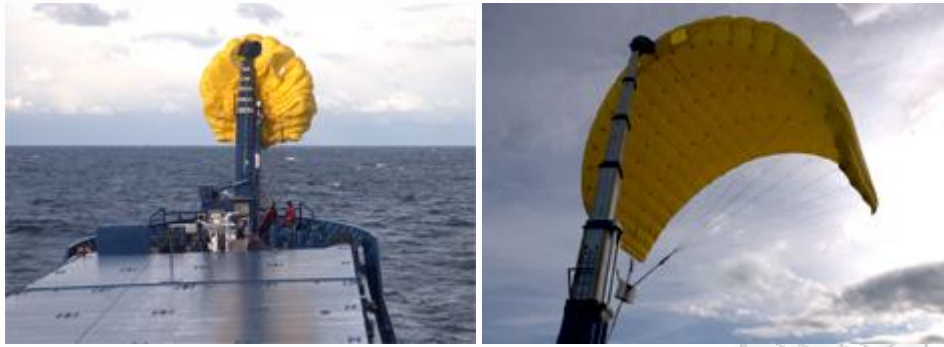
Εικόνα 3.6: Ο τηλεσκοπικός ιστός που εγείρει την ρυμούλκηση του χαρταετού
