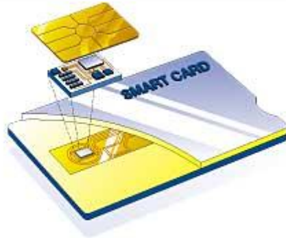
Εικόνα 3-Έξυπνη κάρτα με ενσωματωμένο ολοκληρωμένο κύκλωμα (Chip)
