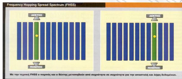
Εικόνα 9 : Τεχνική Δαμόρφωσης FHSS (Frequency Hopping Spread Spectrum) [14]
