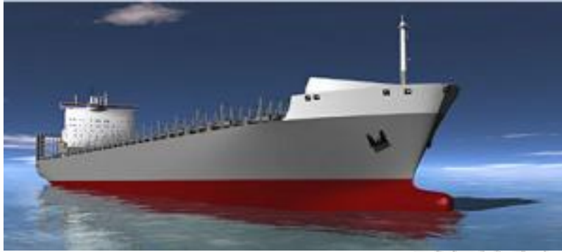
Εικόνα 16 – Βελτιστοποιημένη Γάστρα για την κάλυψη των απαιτήσεων του EEDI (gCaptain- A Maritime & Offshore News Blog (2011) FutureShip's hull design optimization results in significant fuel savings http://archive.feedblitz.com/261222/~3957705 )
