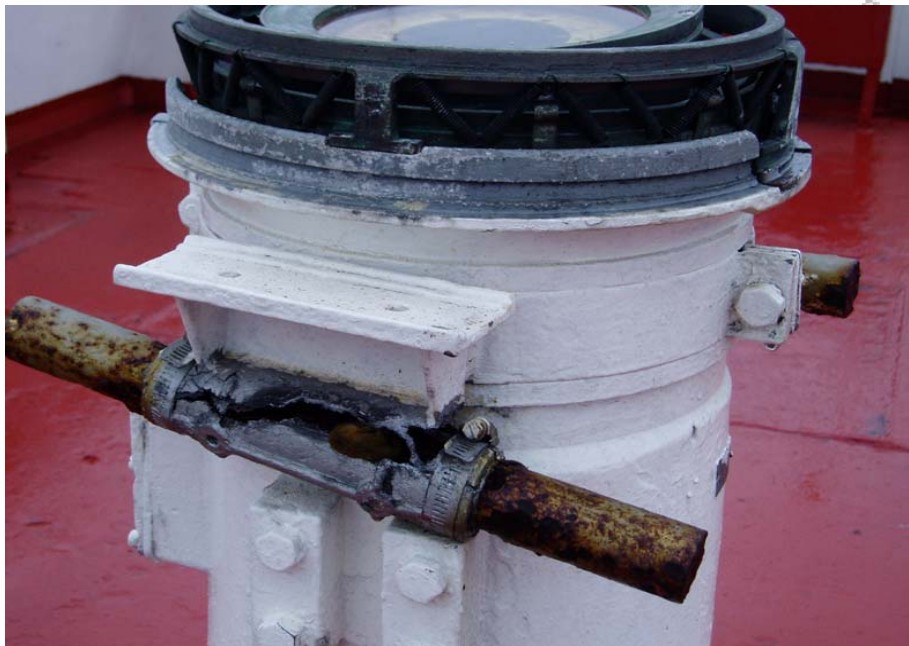
Εικόνα Γ3: Damaged main magnetic compass
