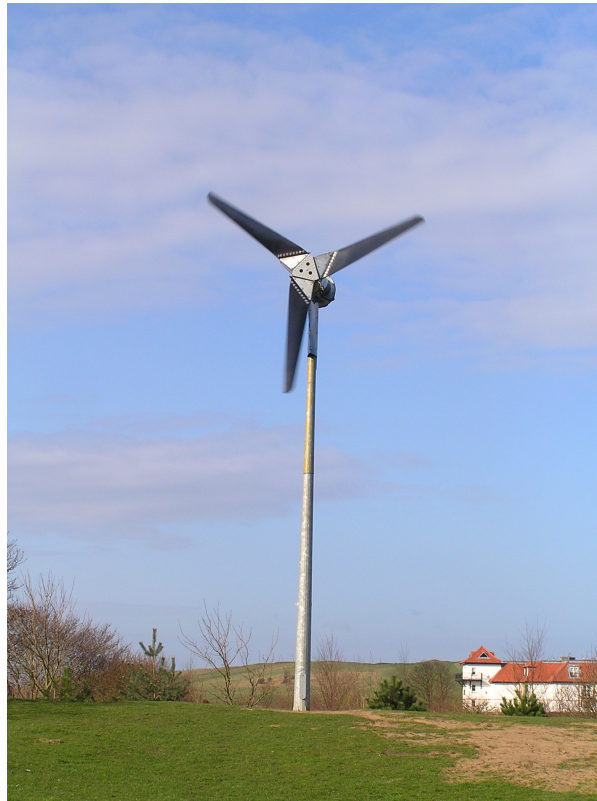
Εικόνα 1.2: Μια ανεμογεννήτρια μερικών kW παρόμοια με αυτές που χρησιμοποιούνται σε μικρά υβριδικά συστήματα
