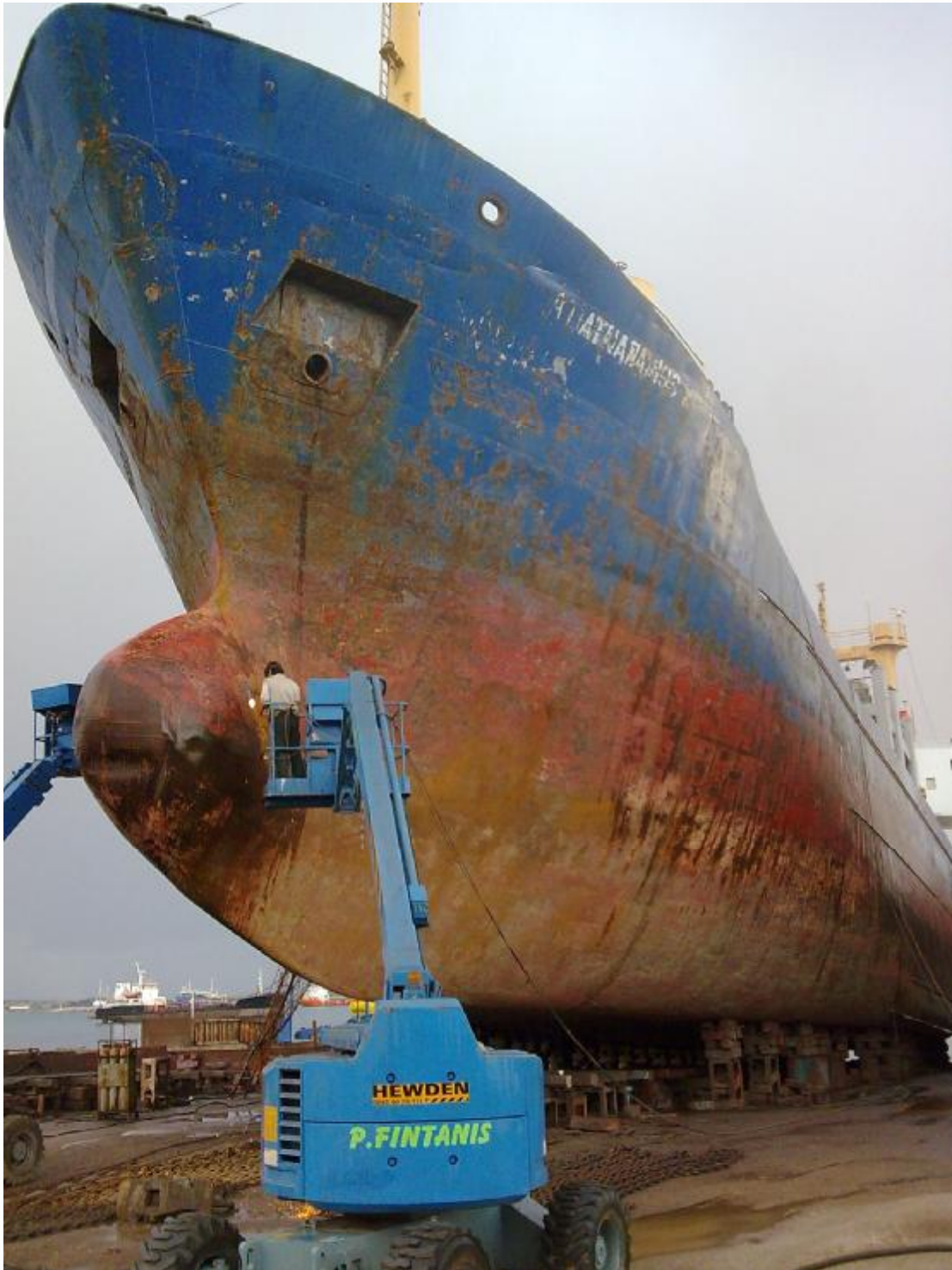
Φορητό Πλοίο της Μεσογείου κατά την διάρκεια Υδροβολής
