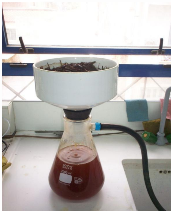
Εικόνα 3: Ηθμός Buchner όπου γίνεται η διήθηση του υλικού υπό κενό.
