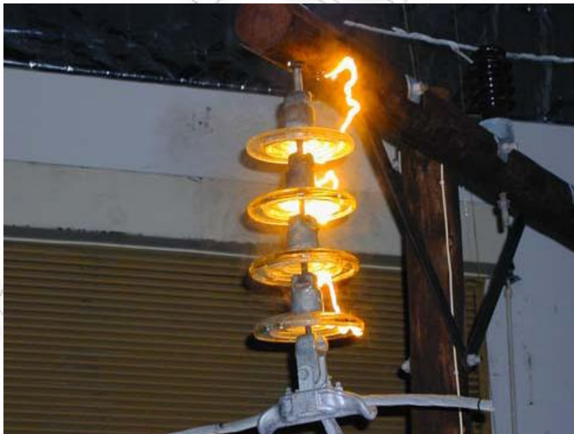
Διάσπαση μονωτήρων – πειραματική διάταξη
