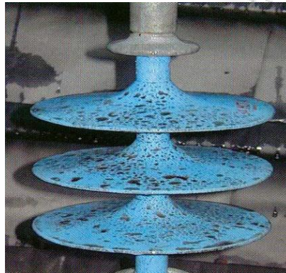
Μονωτήρας που αποικήθηκε από μύκητες στο εργαστήριο
