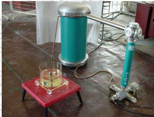
Φωτογραφία της πειραματικής διάταξης διάσπασης των δοκιμίων
