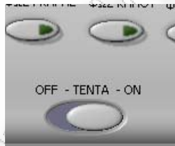
Εικόνα 23. Διακόπτης για το άνοιγμα και κλείσιμο της τέντας και βρίσκεται στον πίνακα ελέγχου
