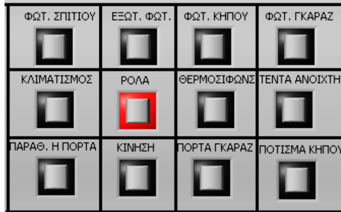
Εικόνα 46. Πίνακας ενημέρωσης με led. Φαίνεται ότι κάποιο από τα ρολά ή όλα, είναι ανοιχτά.
