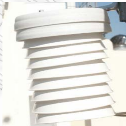
Εικόνα 66. Εξωτερικός αισθητήρας Θερμοκρασίας τοποθετημένος σε πιατοκλωβό. Τοποθετείται πάνω σε ιστό και ψηλά ώστε να μην είναι προστατευμένο από σκιές.
