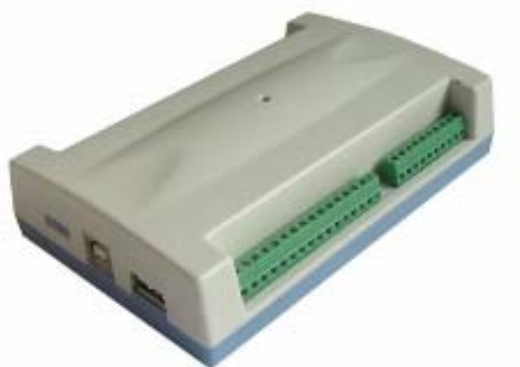
Εικόνα 62. Συσκευή DAQ με 16 input και 8 output. Η σύνδεση της με τον υπολογιστή γίνεται με θύρα usb.
