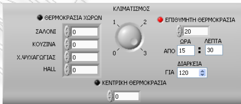
Εικόνα 19. Κεντρικός έλεγχος κλιματισμού που βρίσκεται στον πίνακα ελέγχου και έχει γίνει επιλογή του προγράμματος 3.
