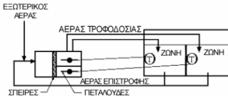
Σχήμα 2.4. Σχηματικό διάγραμμα ενός συστήματος πολλαπλών ζωνών.
