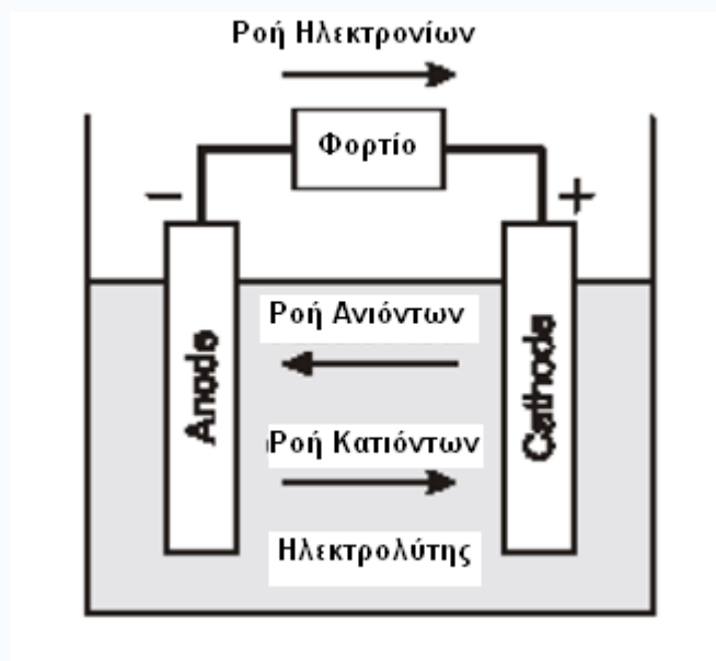
Σχήμα 3.3. Διάγραμμα λειτουργίας Ηλεκτρικής στήλης.
