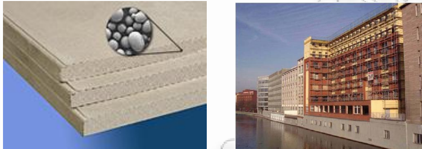
Σχήμα 3.12. Αριστερά: πανό με ενσωματωμένα PCM σε ποσοστό 20%.
