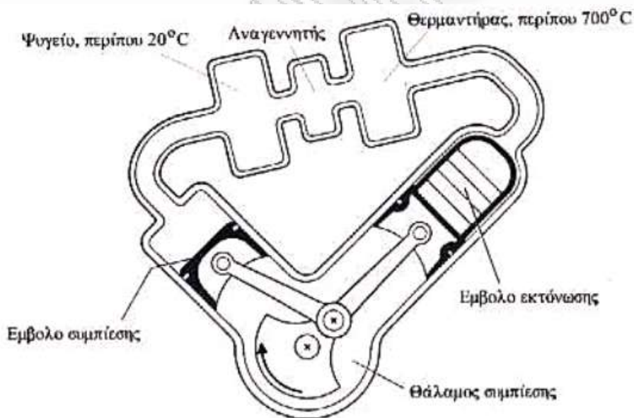
Σχήμα 2-14 Απλοποιημένη απεικόνιση κινητήρα Stirling.
