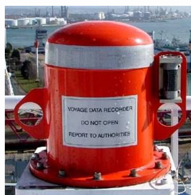
Εικόνα 5. Τα δυο είδη οργάνων καταγραφής στοιχείων ταξιδιών (VDR)
