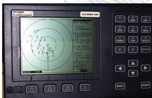
Εικόνα 3. Ένα σύστημα εξοπλισμένο με AIS πάνω σ'ένα σκάφος παρουσιάζει τη συμπεριφορά και την απόσταση των παραπλέοντων σκαφών με μια οθόνη που θυμίζει ραντάρ.
