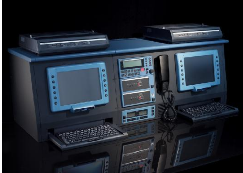
Εικόνα 6. Ένα πλήρες σύστημα GMDSS
