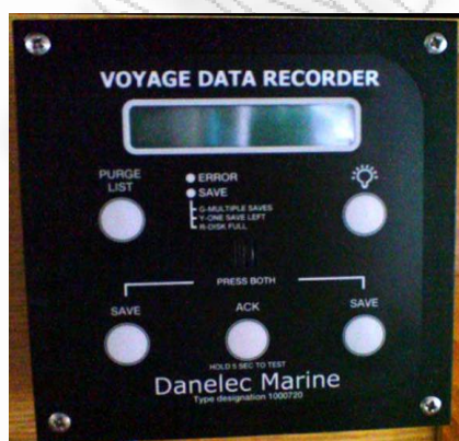
Εικόνα 5. Τα δυο είδη οργάνων καταγραφής στοιχείων ταξιδιών (VDR)
