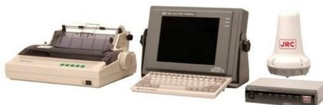
Εικόνα 4. Ένα ολοκληρωμένο σύστημα LRIT
