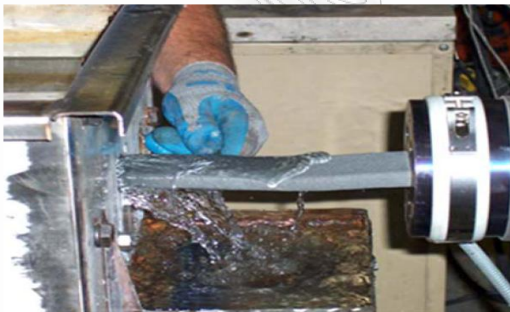
Εικόνα 30 : Διαδικασία εξώθησης μετα-καναλωτικού τάπητα από νάυλον 6, με ενίσχυση 30 % από ίνες υάλου
