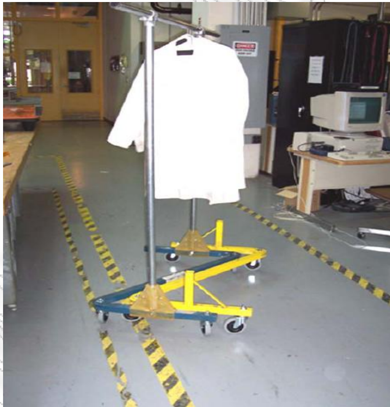
Εικόνα 31 : ράφι τύπου Z-bar, για ρούχα. Ο κίτρινος σκελετός αποτελεί τον πρωταρχικά χρησιμοποιούμενο σκελετό. Ο μπλε σκελετός περιλαμβάνει τα στηρίγματα που κατασκευάστηκαν από μετα-καταναλωτικό τάπητα.
