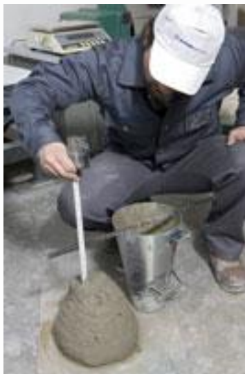
Εικόνα 33 : τεστ κάθισης σκυροδέματος
