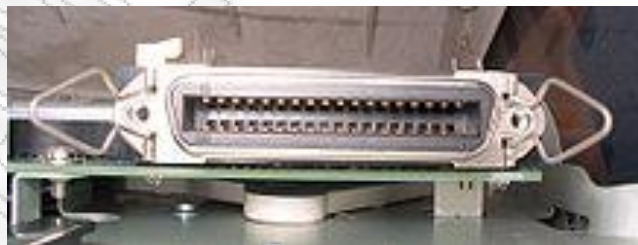
Σχήμα 42: Βύσμα 36 ακίδων (θηλυκό) που χρησιμοποιείτο για βιομηχανική χρήση και στους προσωπικούς υπολογιστές πριν του 1980.
