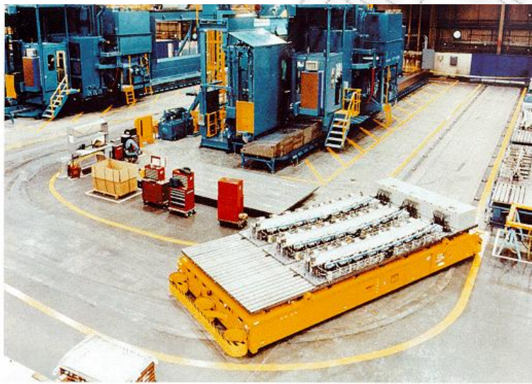
Σχήμα 3: AGV σε Βιομηχανικό Περιβάλλον
