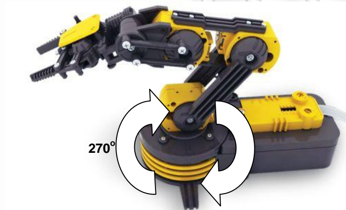
Σχήμα 49: Περιστροφική κίνηση βάσης ρομποτικού βραχίονα
