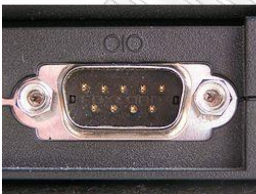
Σχήμα 36: Αρσενικό θύρας RS–232. Το συγκεκριμένο πρότυπο είναι που επικράτησε έναντι όλων των άλλων και είναι το DE–9.
