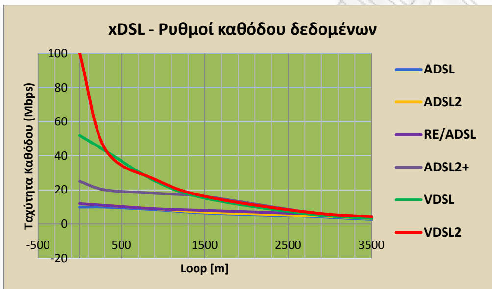
Σχήμα 10. Το VDSL2 προσφέρει ταχύτητες VDSL με κάλυψη και ευελιξία των ADSL/2+ [22]
