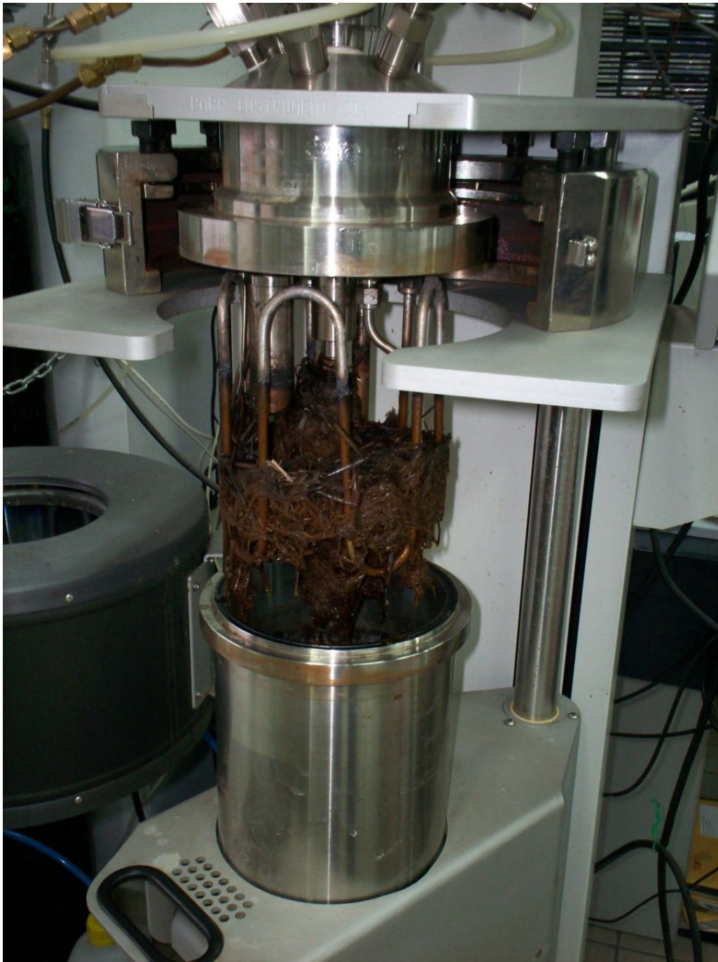
Εικόνα 5.3: Εικόνα του αυτόκλειστου αμέσως μετά το τέλος της αντίδρασης. Διακρίνεται το ανοιχτό δοχείο εντός της βάσης του και το δείγμα άχυρου που έχει υποστεί αντίδραση.
