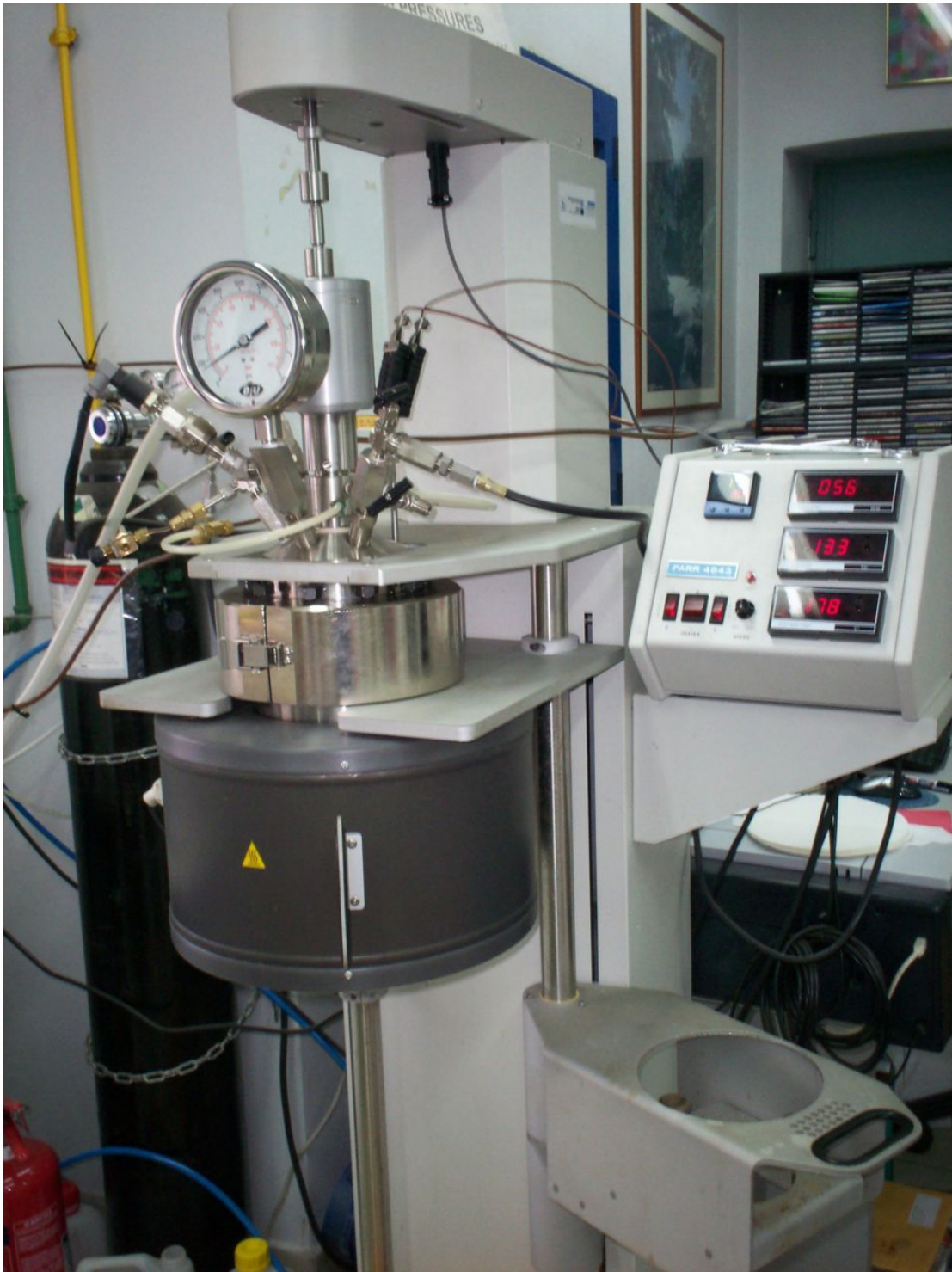
Εικόνα 5.2: Εικόνα του αυτόκλειστου όπου διακρίνονται το δοχείο, η βάση του δοχείου και ο θερμαντικός μανδύας που περιβάλλει το δοχείο.
