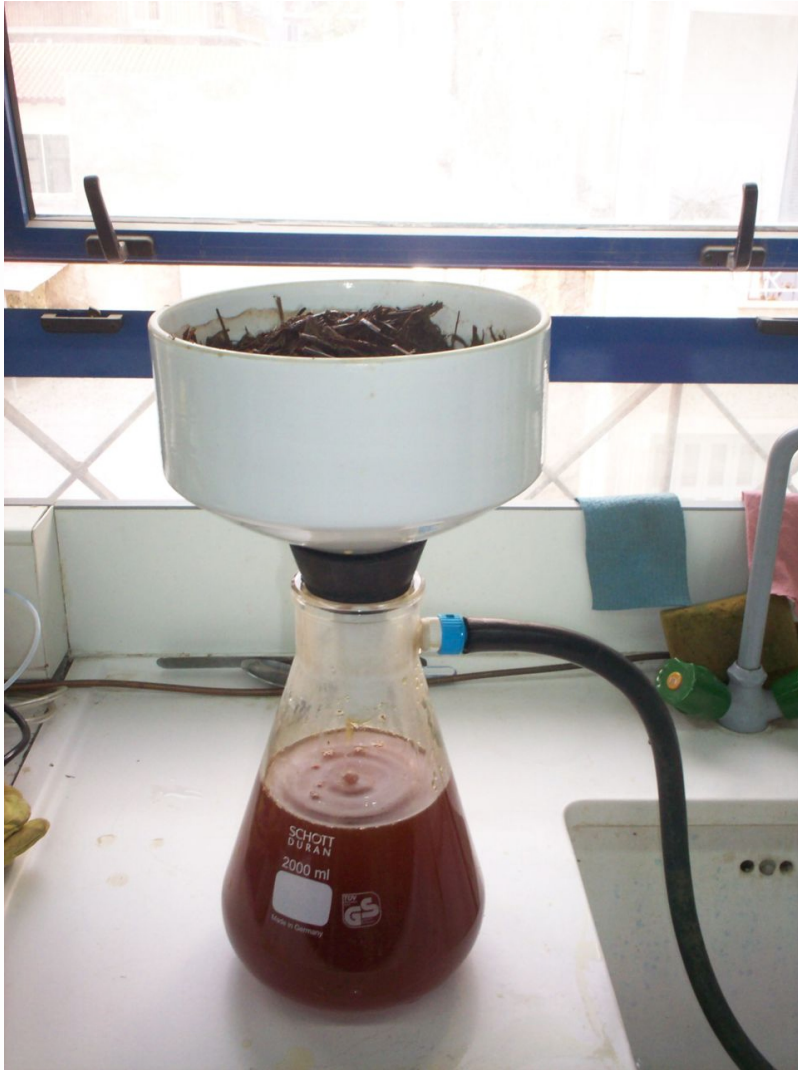
Εικόνα 5.4: Ηθμός Buchner όπου γίνεται η διήθηση του υλικού. Παρατηρείται ο σωλήνας υποπίεσης ο οποίος βοηθάει στην επιτάχυνση της διαδικασίας.
