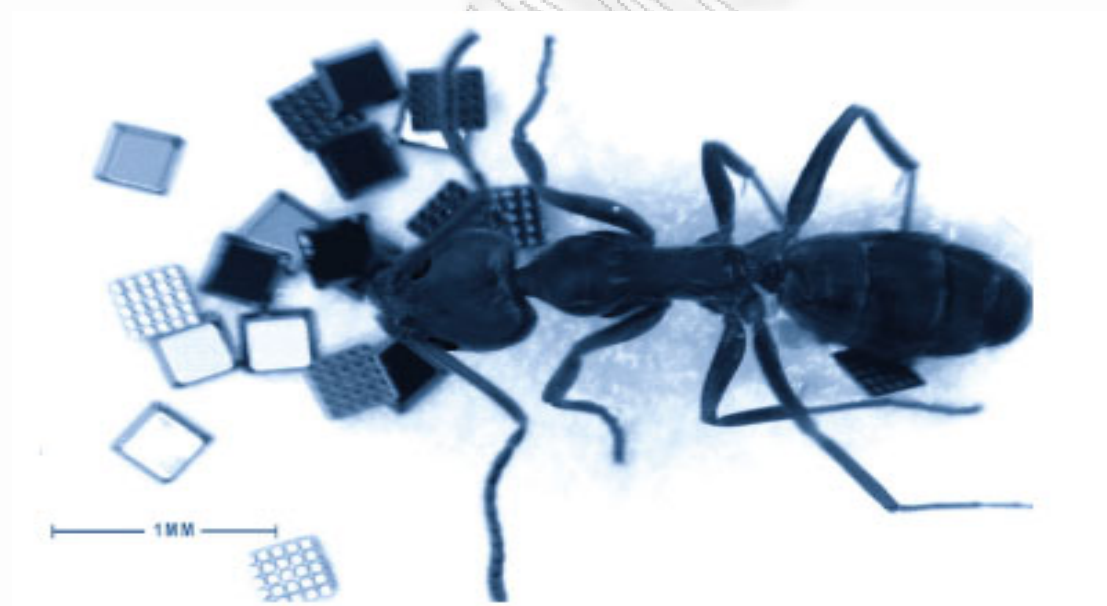
Εικόνα 2: μέγεθος RFID passive tags σε σχέση με το μέγεθος ενός μυρμηγκιού
