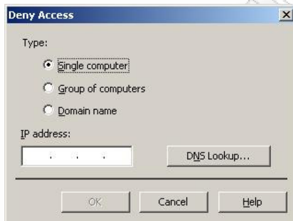
Εικόνα 12 Οθόνη δημιουργίας νέας καταχώρησης στη λίστα εξαιρέσεων βάσει IP διεύθυνσης (Single computer), εύρους IP διευθύνσεων (Group of computers) ή ονόματος domain (domain name)
