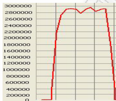
Σχήμα 48 Μέτρηση της τιμής του bit-rate για τη μεταφορά ενός αρχείου 96mb σε ένα δίκτυο 802.11g με Fragmentation threshold ίσο με 2048 byte.
