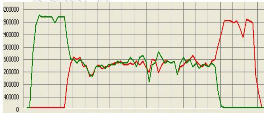
Σχήμα 30. Γραφική απεικόνιση του throughput του δικτύου κατά την μεταφορά του αρχείου σε δύο clients.
