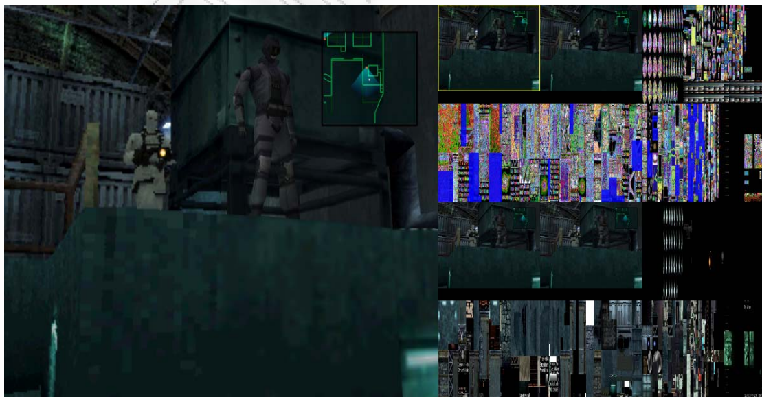
Σχήμα 36. Δημιουργία “κενών” κατά την μετάδοση βίντεο με μεγαλύτερο bitrate από το throughput του δικτύου.
