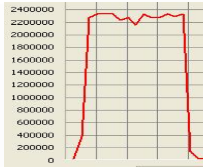
Σχήμα 47 Μέτρηση της τιμής του bit-rate για τη μεταφορά ενός αρχείου 96mb σε ένα δίκτυο 802.11g με Fragmentation threshold ίσο με 1024 byte.
